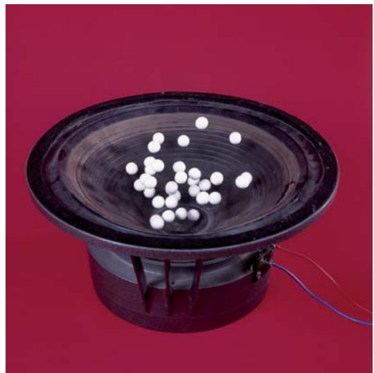
Membrana konike e altoparlantit oscilon
