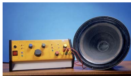
Gjeneratori i sinjaleve prodhon tone me frekuenca të ndryshme.
