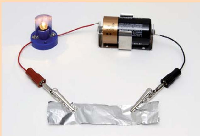
Testim i përçueshmërisë së një cope të folisë së aluminit
